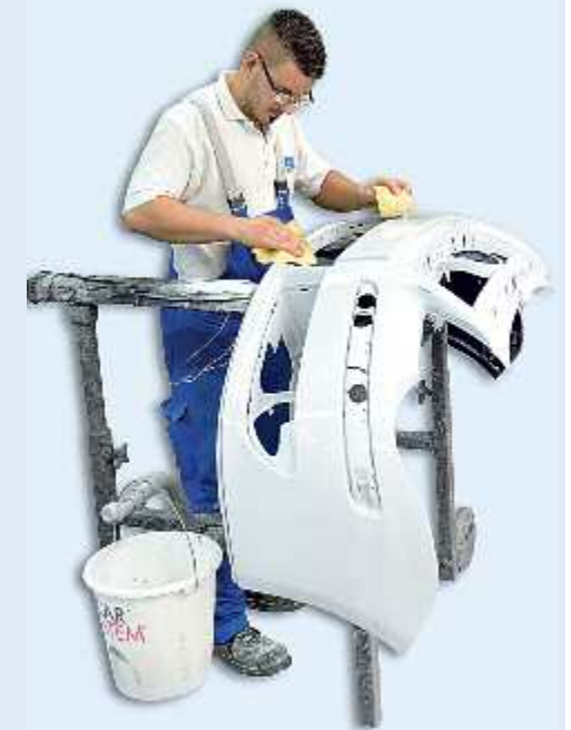
Csaba Szamosi bereitet das Schleifen einer Stoßstange vor
